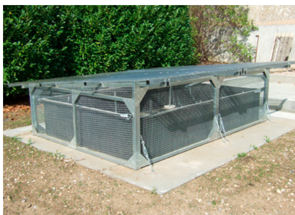
L'Héliosec® est protégé par un grillage pour éviter les intrusions
