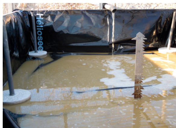
Contrôle du niveau d'effluents au moyen d'une jauge graduée
