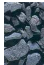
Concassé 2/7 mm Pour des ouvrages minces (< 5 cm), de formes compliquées, ou fortement armés.
