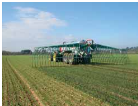
Photo 10: Rampe à pendillards
