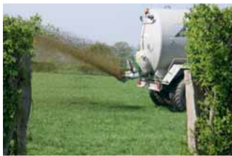
Photo 1: buse palette classique (non inversée), à présent interdite sur les tonneaux de plus de 10.000 L
