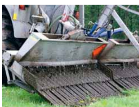
Photo 15: Système à gouttières Tobroco
